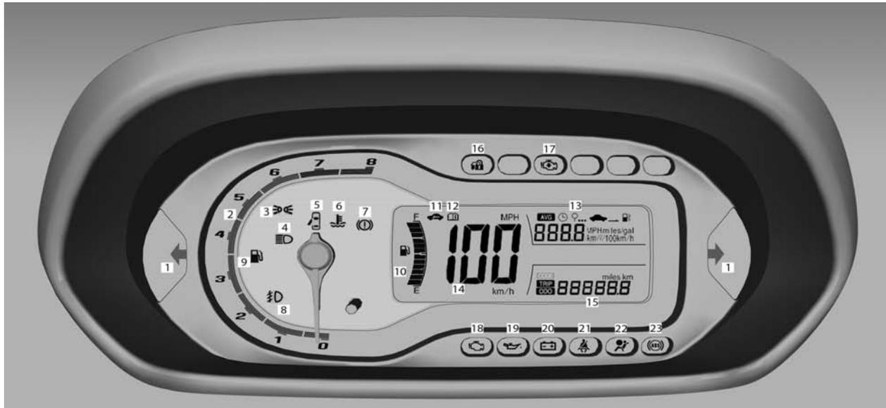
Indikator kontrol di instrumen untuk Mesin Bensin (model A)
