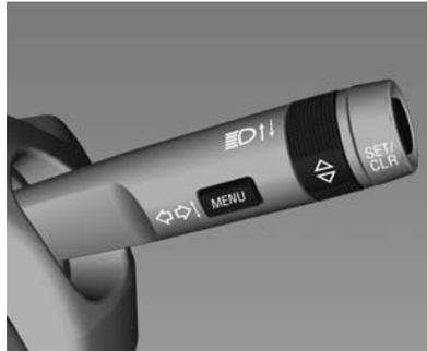
Untuk mengoperasikan tripmeter (penghitung perjalanan dalam satu waktu), tekan tombol **MENU** di tuas sinyal tanda belok.
