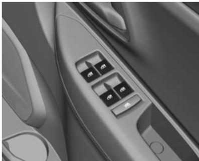
Operasikan sakelar untuk masing-masing jendela dengan menekan sakelar untuk membuka jendela atau menarik sakelar untuk menutup jendela.
