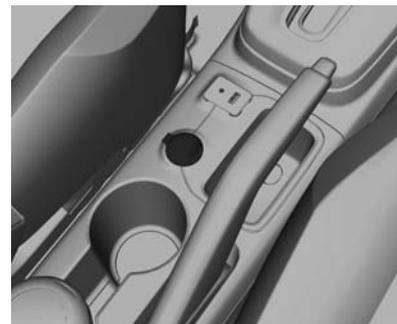
Outlet daya 12 Volt terletak di konsol tengah.
