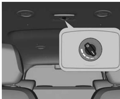
Kipas penyejuk udara belakang membantu aliran udara ke ruang penumpang bagian belakang melalui ventilasi udara belakang.
