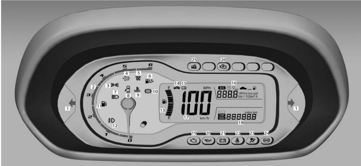
Indikator kontrol di instrumen untuk Mesin Diesel (model A)
