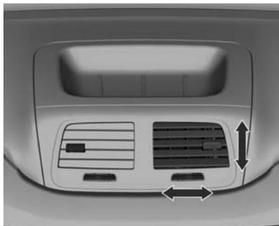
Arahkan aliran udara dengan memiringkan dan memutar siripnya dan roda penyetel.
