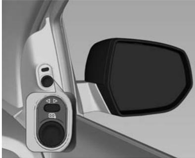
Pilih spion luar kiri atau kanan pada sakelar selektor dan setel dengan sakelar empat arah.
