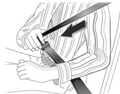
Tarik sabuk dari retractor, posisikan tanpa terpelintir melewati badan dan pasang pelat pengunci ke gesper sabuk. Atur tegangan secara reguler sabuk bagian bawah selagi duduk dengan cara menyentak sabuk bagian atas.
