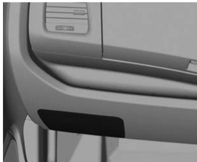
Kotak sekering berada di bagian kiri panel instrumen. Lepas tutup panel bawah untuk mengaksesnya.
