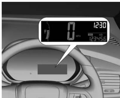
Untuk menyetel waktu pada Tampilan Model B, tekan tombol kluster selama kurang dari 2 detik, seperti pada gambar di bawah.
