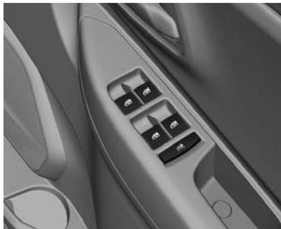
Operasikan sakelar untuk masing-masing jendela dengan menekan untuk membukanya dan menarik untuk menutupnya.
