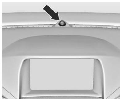
LED Status terintegrasi dalam sensor di bagian atas panel instrumen.
