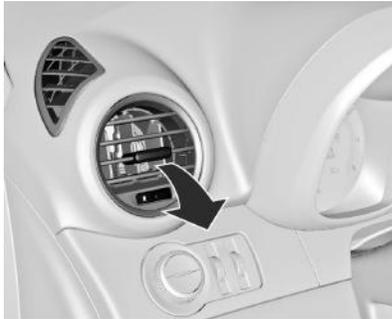
Arahkan aliran udara dengan memiringkan dan memutar siripnya.
