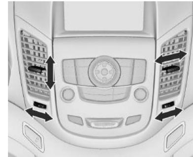
Putar roda penyetel untuk membuka atau menutup ventilasi atau untuk menyesuaikan jumlah udara.
