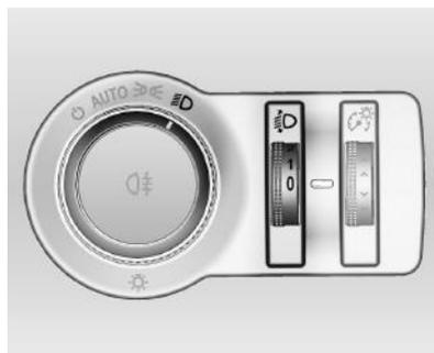
Untuk menyesuaikan jangkauan lampu depan terhadap muatan kendaraan untuk mencegah kesilauan pandangan: putar kenop ke posisi yang diperlukan.
