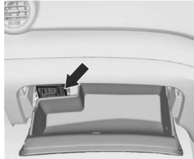
Pada kendaraan dengan setir kanan, kotak sekering terletak dalam laci mobil.
