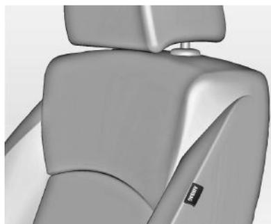
Sistem kantung udara samping terdiri atas sebuah kantung udara di tiap sandaran punggung tempat duduk depan. Kantung udara ini bisa dikenali dengan tulisan **AIRBAG**.
