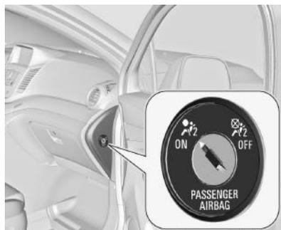
Sistem kantung udara penumpang depan dapat dinonaktifkan melalui sakelar berkunci di sisi kanan panel instrumen.
