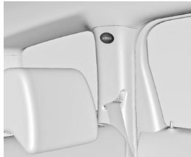
Sistem kantung udara tirai terdiri dari sebuah kantung udara di rangka atap tiap sisi. Kantung udara ini bisa dikenali lewat tulisan **AIRBAG** pada tiang-tiang atap.
