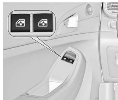
Operasikan sakelar untuk masing-masing jendela dengan menekan untuk membukanya dan menarik untuk menutupnya.
